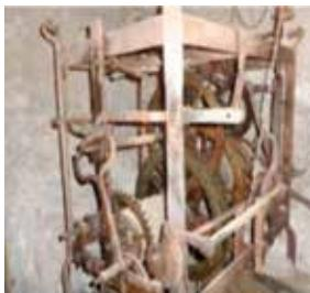
Allo stato attuale l'orologio non espleta le sue funzioni a causa del non funzionamento dell'apparato di ricarica dei pesi e per la mancanza di manutenzione ordinaria degli organi di movimento meccanici. L'assenza di manutenzione da parte di personale competente e la mancanza di pulizia hanno compromesso il corretto e costante funzionamento.
