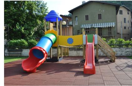
Oltre alla completa **manutenzione dei giochi esistenti** (carteggiatura, chiusura delle fessurazioni con materiale silicico, doppia stesura dell'impregnante all'acqua ecologico, controllo della bulloneria e della viteria e sostituzione delle parti marce e pericolose), **il parco si è arricchito di una nuova altalena, di un nuovo gioco a molla e di un nuovo "castello".**
